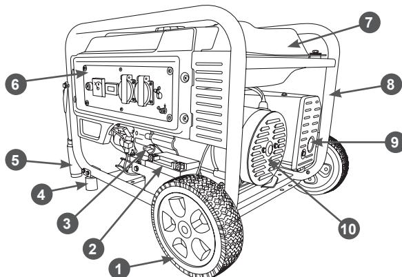
**Рис. 1 Основные узлы и органы управления (общий вид)**
