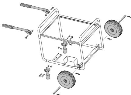
Рис. 4 Установка колёс, рукояток и опор рамы GG3200EW
